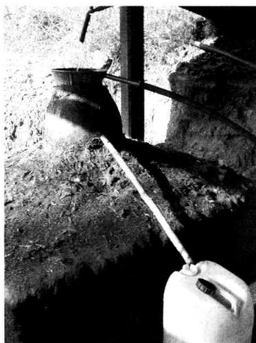
Figura 6. Destiladora con base en ollas.
