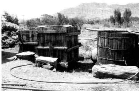
Figura 5. Tinajas de madera para la fermentación del maguey cocido.
